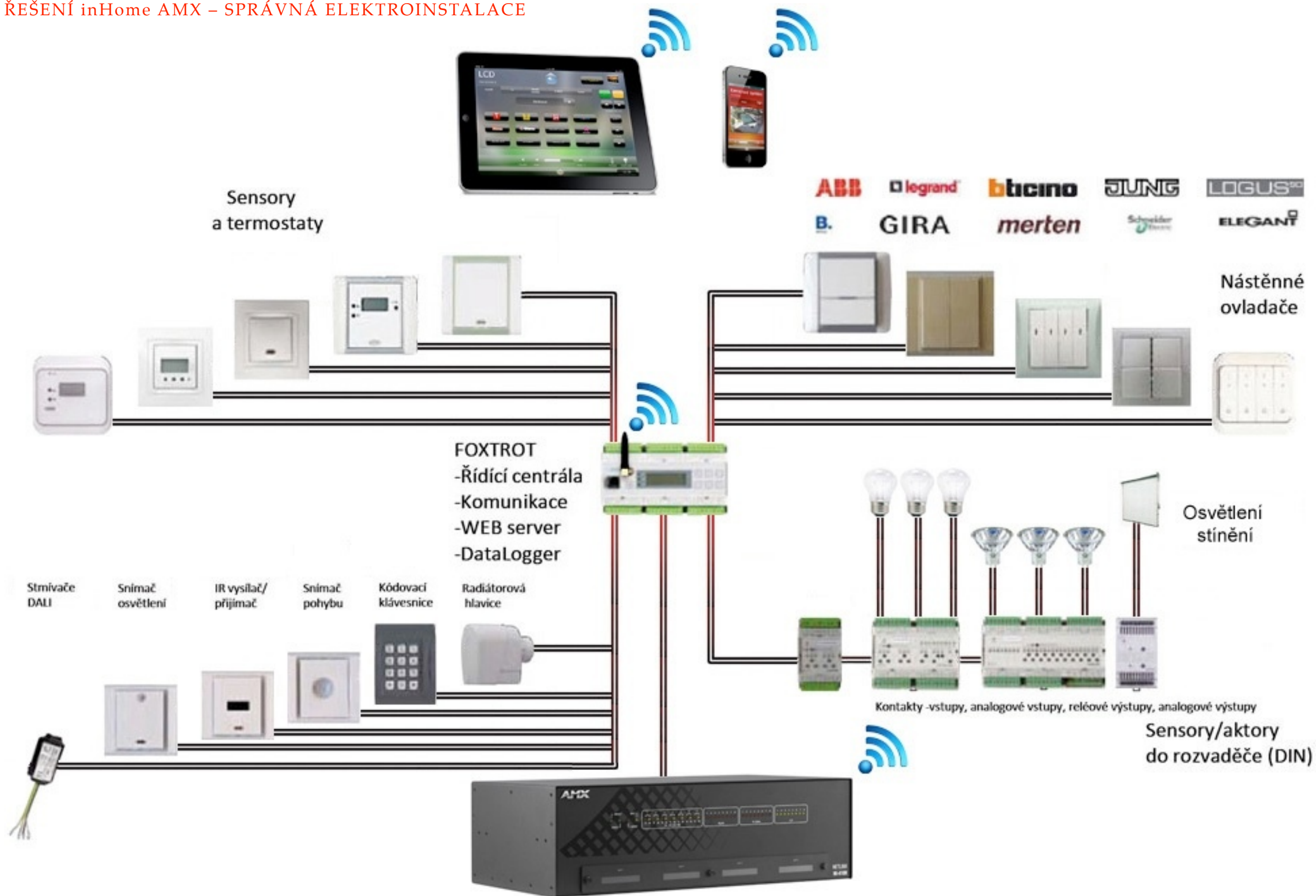
Systémová elektroinstalace, hvězda – FOXROT + AMX
